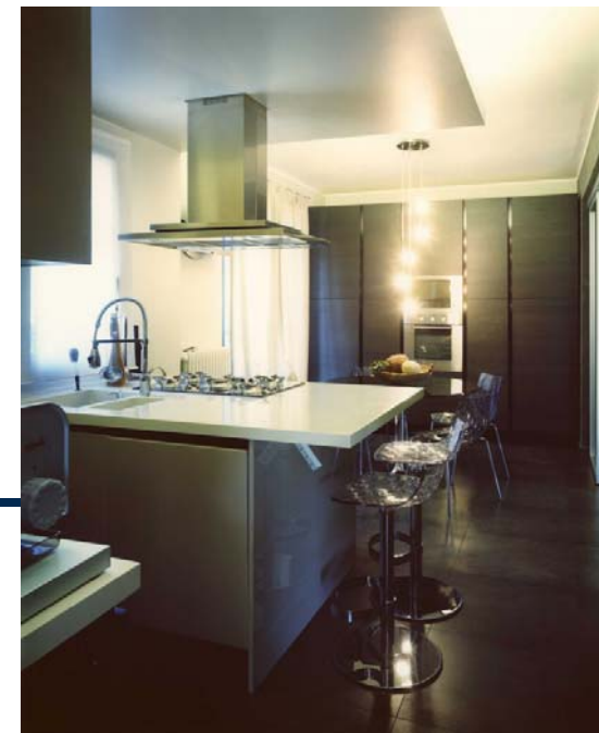
Particolare della zona giorno: zona giorno con veletta in cartongesso provvista di luce di bordo e posa di pavimento in parquet
